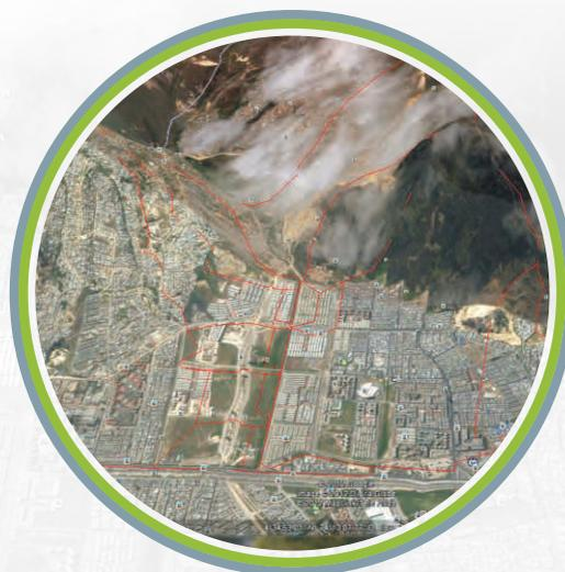
Alcance: Estudios y Diseños Detallados, Catastro de Redes, Hidrología, Modelación Hidráulica, Topografía, Geotecnia y Diseños Estructurales para el Colector Pluvial Terreros, Longitud: 2 Km , Diámetros: Ø 2.40 m hasta Ø 3.00 m, Material: GRP, Área de Drenaje: 286 ha, Caudal de Diseño: 20 m<sup>3</sup>/s.
